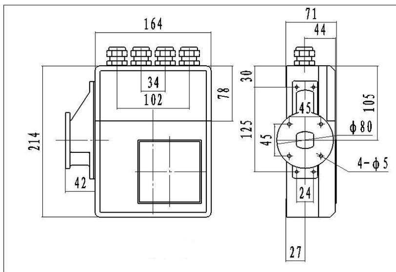
图 4.1.5 (b) 电磁热量表外形尺寸图
