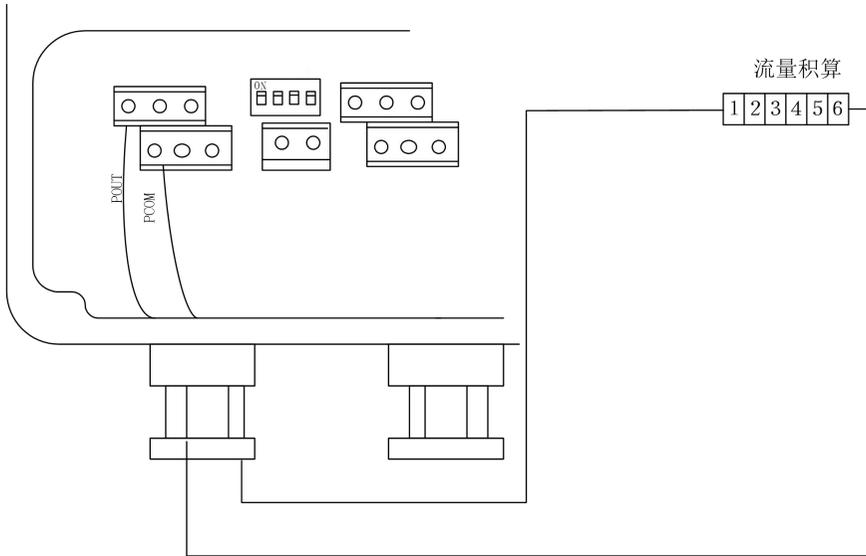
图 7.3.3 (c) 电子计数器接线
