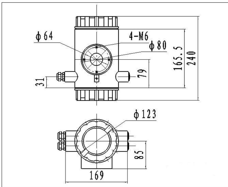
图 4.1.5 (a) 圆形壳体一体式外型尺寸图
