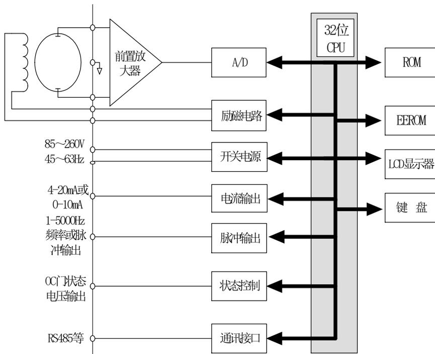
图 4.2 转换器电路结构
