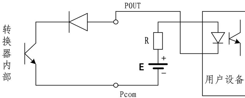
图 7.5.3.2 数字量输出接光电耦合器
