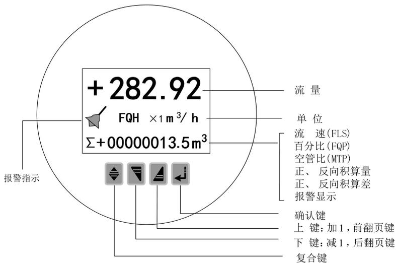
图 7.1.2 圆表键盘定义与液晶显示
