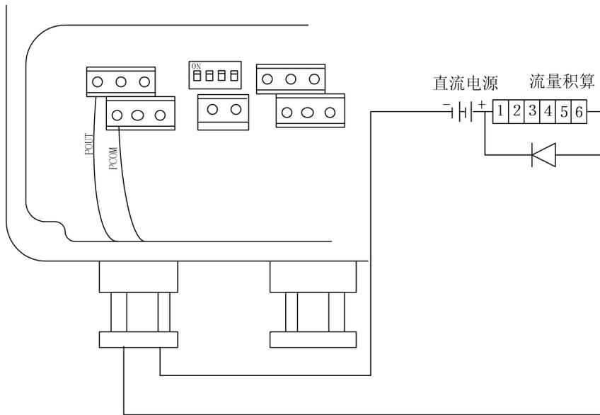
图 7.4.3 (b) 电磁计数器接线
