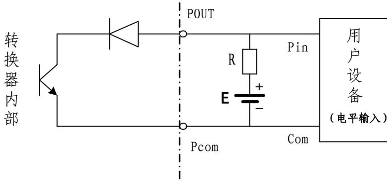
图 7.5.3.1 数字量电平输出接法
