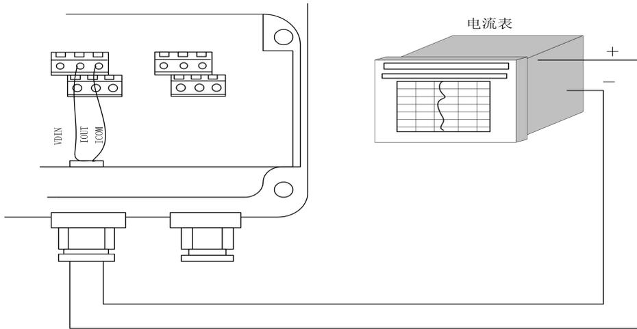
图 7.4.3 (a) 电流输出接线图
