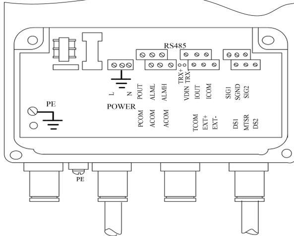
图 7.3.1 方表接线端子图
