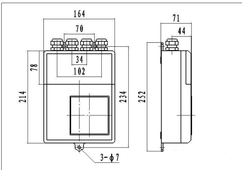
图 4.1.5 (c) 方型壳体分体式外型尺寸图
