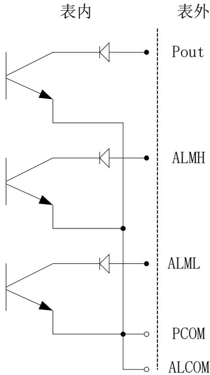
图 7.3.3 (e) 表内 OC 门连接方式
