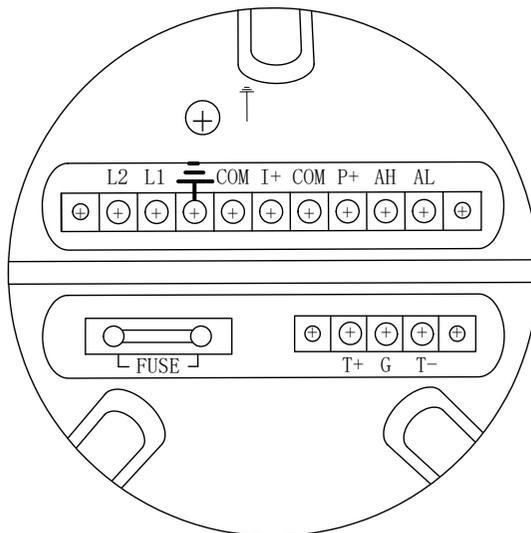
图 7.3.3 圆表接线端子图
