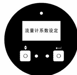
在流量计系数设定时，超过2分钟按键无动作会自动超时退出，流量计系数输入完成之后会出现确认界面，短按左键取消，短按右键确定，选择确定即可将输入的流量计系数用于之后的流量计算，输入的系数范围必须在0到10之间，否则会提示数字大小超限。
